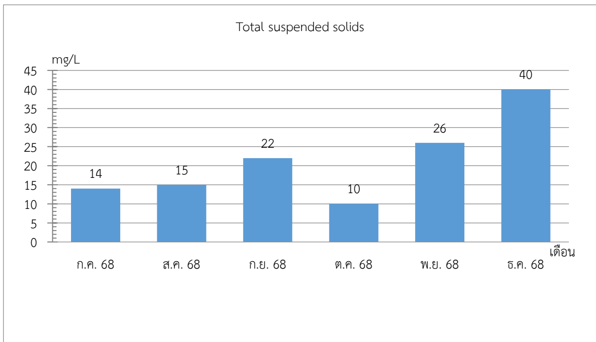
รูปที่ 3.48 กราฟแสดงผลการตรวจวิเคราะห์ TSS จุดที่ 2 บริเวณถังปรับสภาพสมดุลของระบบบำบัดน้ำเสียอาคาร B
